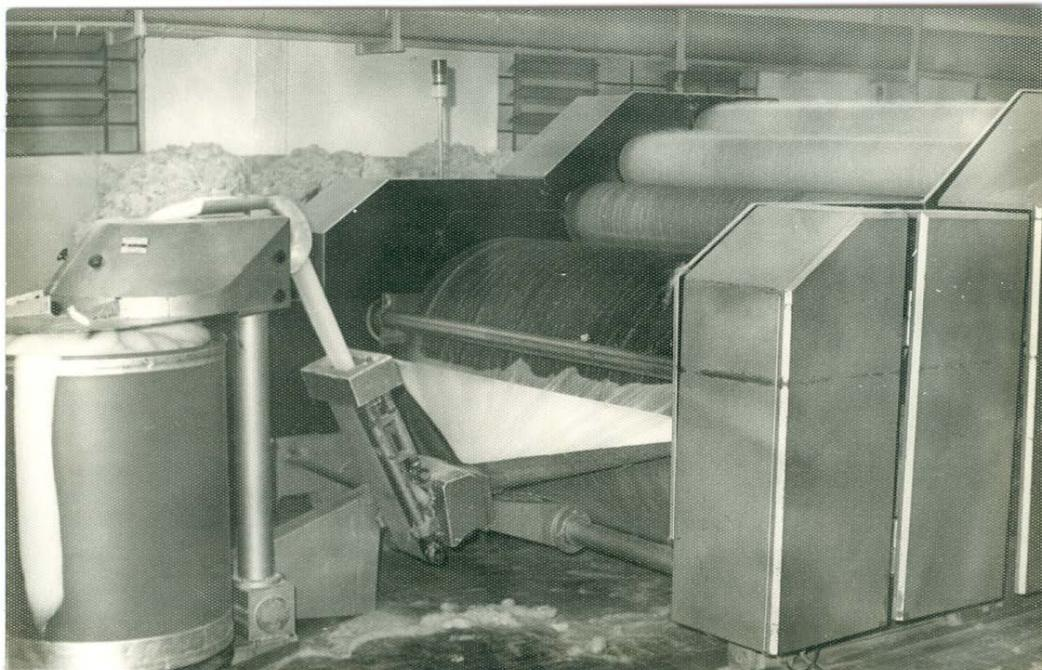
Figura 34- Máquina de cardagem de lã, fotografia PB, s/ data.
