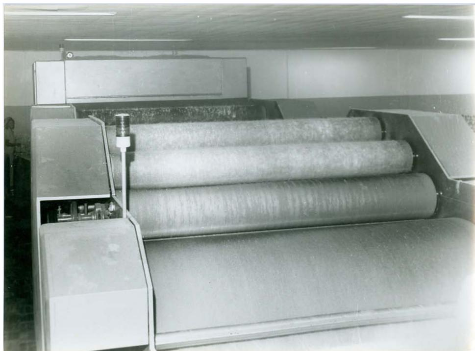
Figura 62- Máquina de cardagem de lã, fotografia PB, s/ data.
