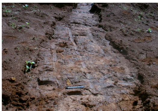
Figura 11: Estrutura laminar coesa gerada pelo tráfego intenso de máquinas pesadas (a) e quebra desta massa coesa com a escarificação (b).
