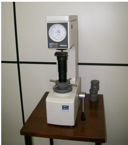
Figura 22 – Durômetro utilizado na verificação da dureza da ponteira original.
