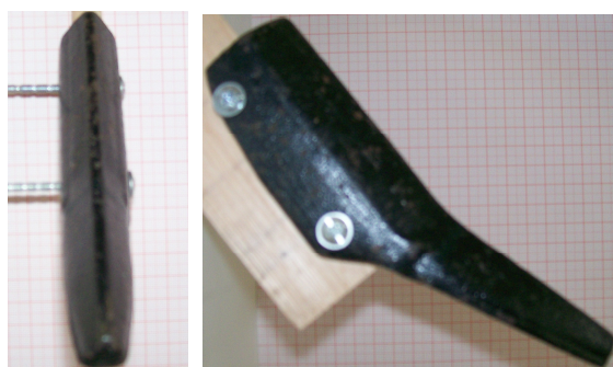
Figura 20 – Ponteira testemunha sem soldagem de revestimento.
