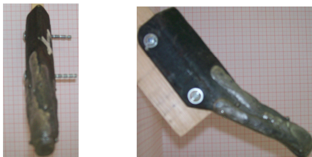
Figura 45 – Recomendação da posição de revestimento com arame tubular.
