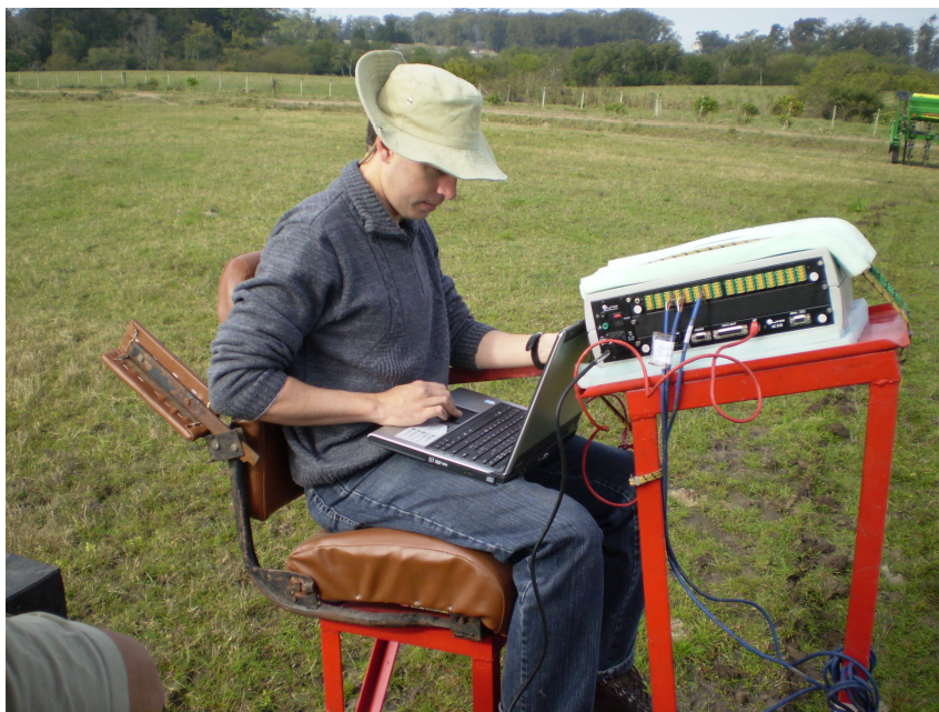
Figura 10 – Instrumentação de aquisição de dados e computador para armazenamento das informações.
