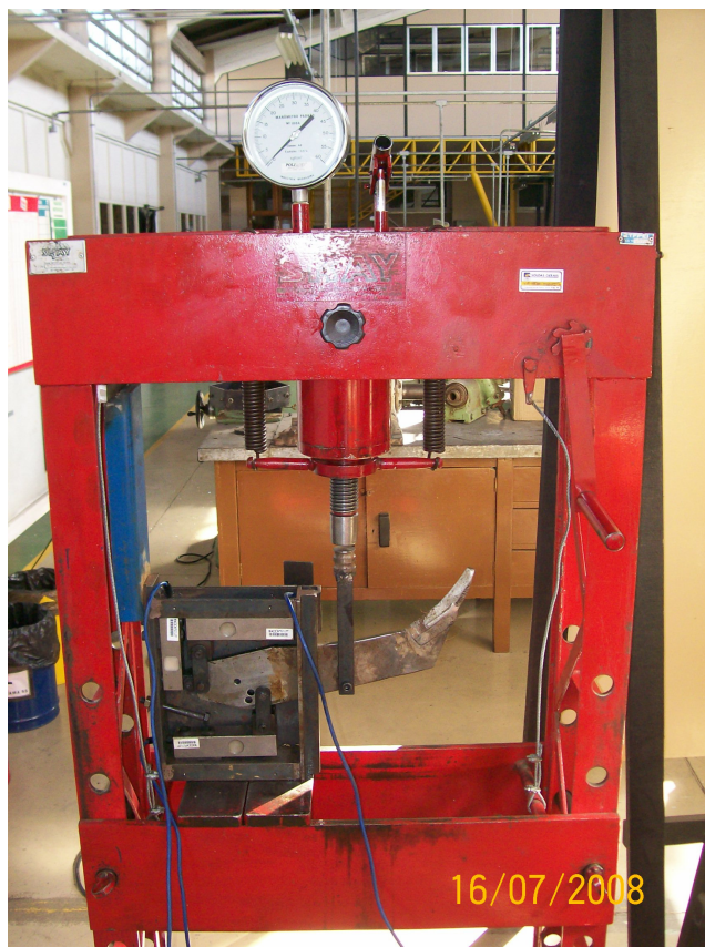
Figura 11 – Prensa hidráulica e manômetro utilizado na calibração das células de carga.
