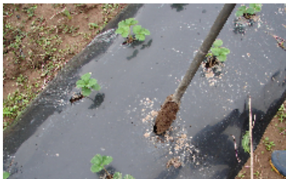
Figura 12 – Coleta de solo utilizando trado holandês.
