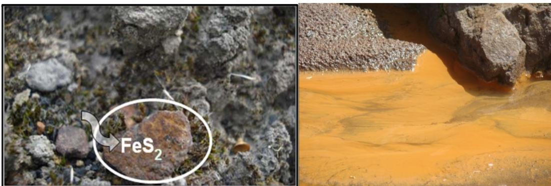
**Figura 4.** Efeito da exposição da pirita e formação do processo de drenagem ácida (fonte: próprio autor).
