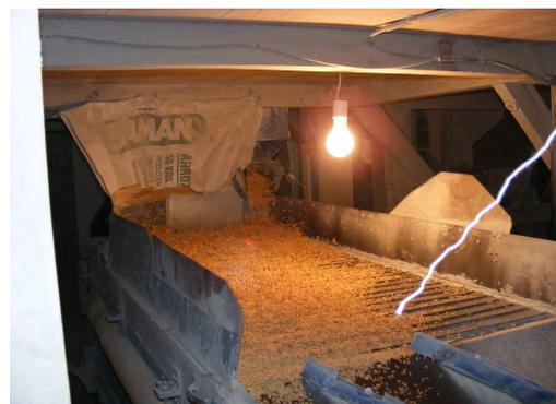
Figura 21. Iluminação elétrica sem blindagem
