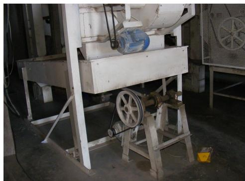
Figura 77. Transmissão de máquina de limpeza sem proteção
