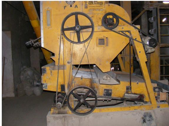
Figura 19. Correias e polias de máquina de limpeza sem proteção
