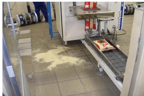
Figura 60. Máquina sem desligamento automático
