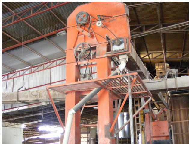
Figura 4. Plataforma de manutenção do elevador sem guarda corpo
