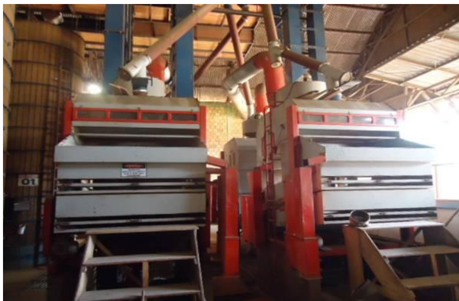
Figura 3 – Máquina de ar e peneiras (pré-limpeza) na UBS da Sementes Petrovina, MT.
