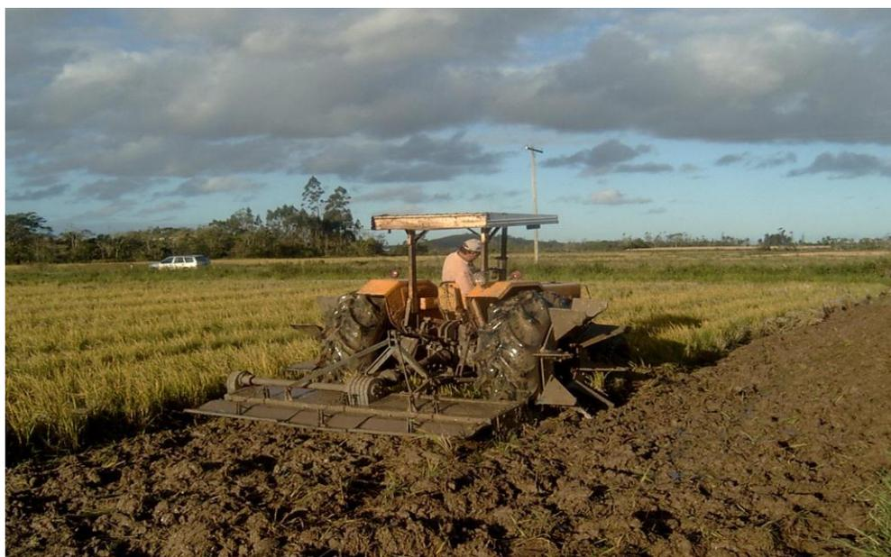
**Figura 3. Primeira etapa de preparo do solo com enxada rotativa logo após a colheita para incorporação da palha. Fonte: Garcia (2012).**
