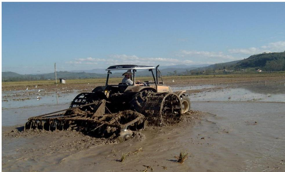
**Figura 4. Preparo do solo com lâmina de água para facilitar o nivelamento. Fonte: Garcia (2012).**
