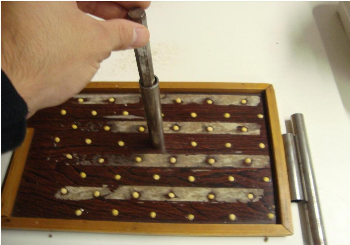
**Figura 2.** Sementes dispostas no contador de sementes de furo redondo com diâmetro de 8 mm, para receberem o impacto através de um peso 100g. Capão do Leão – RS, 2013.
