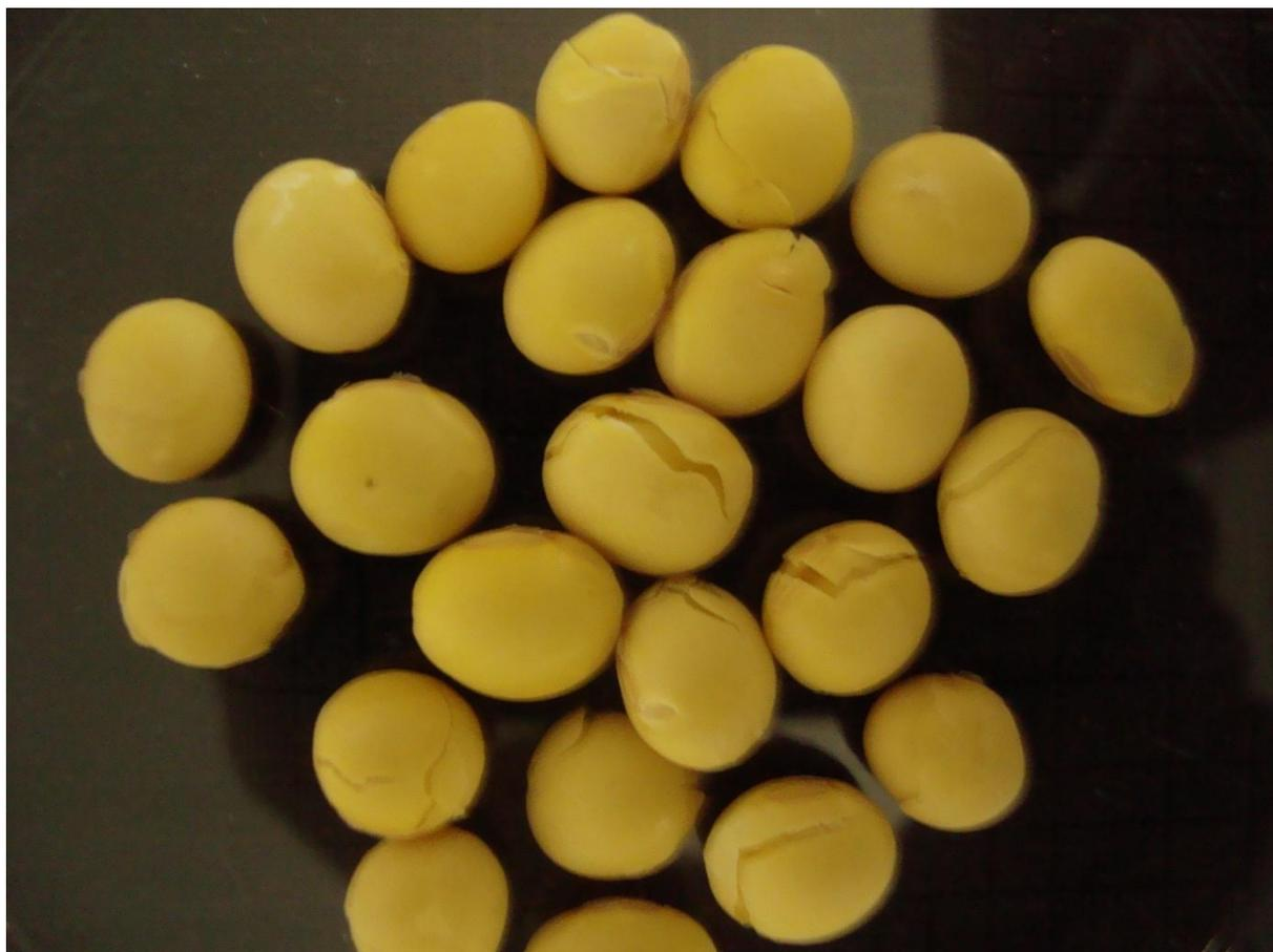
**Figura 4.** Sementes de soja altamente danificadas pelo teste do impacto. Capão do Leão – RS, 2013.
