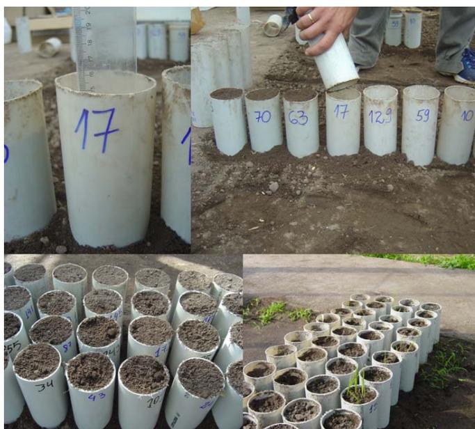
**FIGURA 4.1** – Detalhes da montagem do teste fisiológico de germinação em grandes profundidades.
