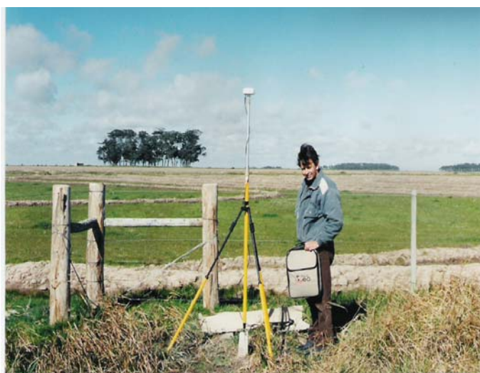
Figura 1 - Montando a base do GPS GTR-1, próxima ao hangar da Granja do Salso
