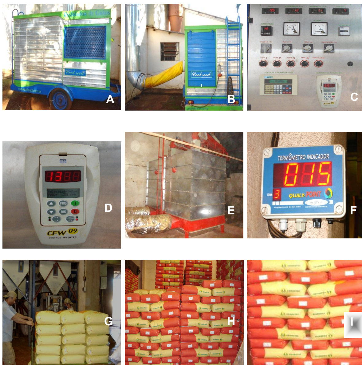
Figura 01 - Processo de resfriamento das sementes, onde, A: resfriador Cool/ Seed , B: detalhe da saída do ar resfriado, C: painel de controle do resfriador, D: temperatura do ar na saída do resfriador; E: silo de resfriamento das sementes, F: temperatura do ar no momento de entrada na massa de sementes, G: ensaque das sementes após o resfriamento, H: acondicionamento dos sacos no armazém, I: detalhe do acondicionamento dos sacos (Fotos: Canton). UFPel, 2010.
