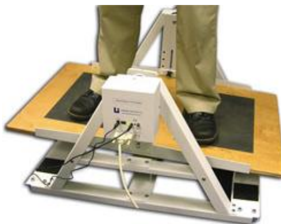
Figura 1 – Plataforma de equilíbrio modelo 16030 (Lafayette Instrument).
