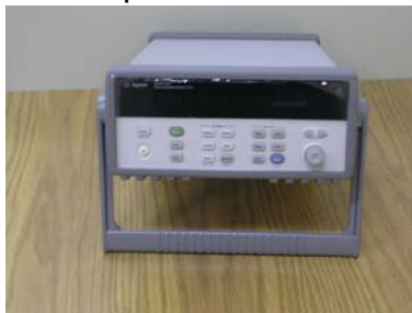
Figura 20 - Agilent 34970A – Sistema de Aquisição de Dados.
