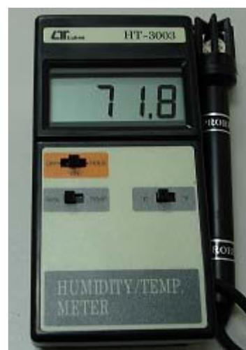
Figura 20 - À direita - *Humidity/Temp. Miter*, fabricado pela *Lutron*, modelo HT-3003
