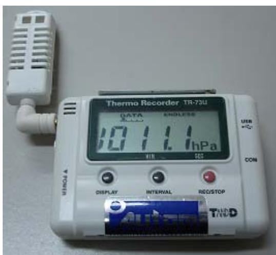
Figura 19 - À esquerda - *Thermo Recorder*, fabricado pela *T&D Corporation*, modelo TR-73U
