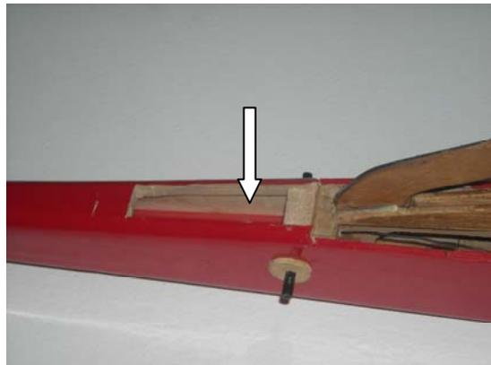
Figura 27 – Indicação da abertura para colocação da instrumentação.
