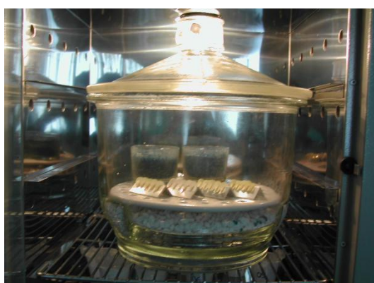
Figura 6. Posicionamento de corpo de prova para metodologia de sorção e solubilidade.
