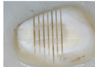
Fig. 2c: Cortes realizados em dente restaurado, para obtenção dos palitos.
