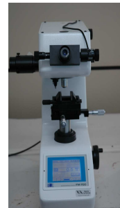
Fig. 3d: Aparelho durômetro, cuja parte óptica será utilizada para realização da análise de fratura.
