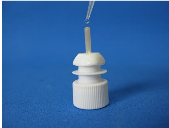
Figura 4 - Suspensão bacteriana colocada sobre a extremidade aberta do tubo de polietileno que contém o material.
