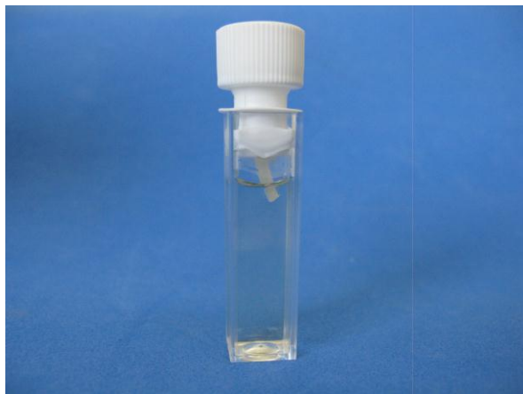
Figura 5 - Caldo BHI na cubeta e o aparato inserido de forma a tampar a cubeta.
