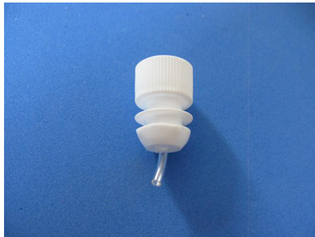
Figura 2 - Aparato: tampa+tubo polietileno.
