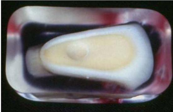
**Figura 1.5** – Cavidade cilíndrica com 4,0mm ( $\pm 0,01$ ) de diâmetro e 1,0mm ( $\pm 0,01$ ) de profundidade.
