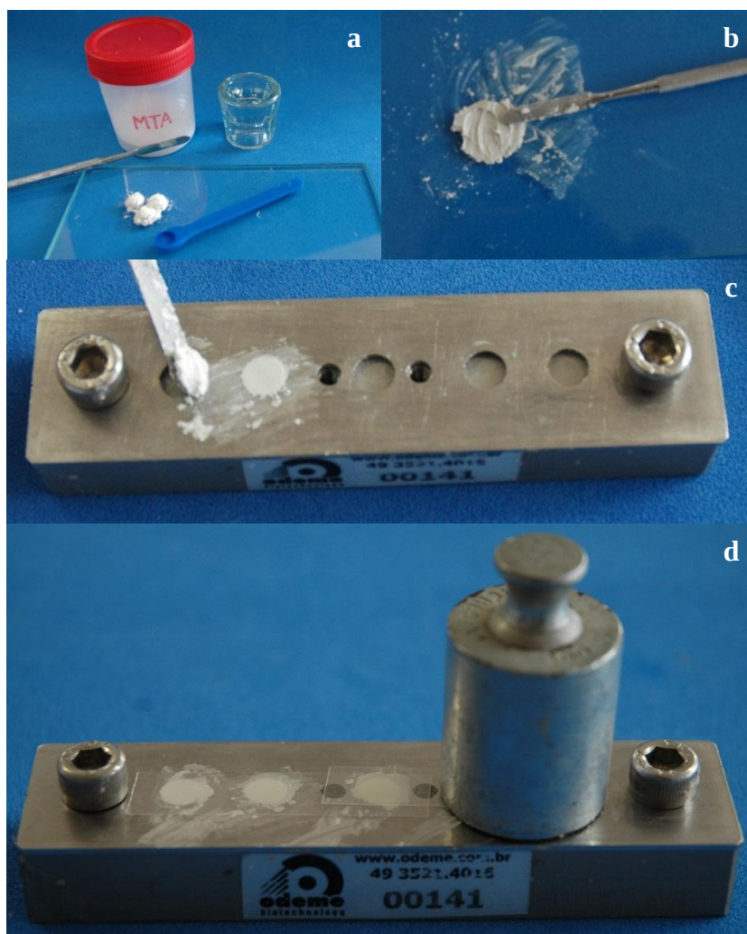
Figura 2- Confeção dos corpos-de-prova; a) Proporcionamento; b) Manipulação; c) Inserção do cimento na matriz; d) Carga posicionada sobre os corpos-de-prova.
