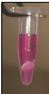
Figura 6. Corpo de prova imerso em 1 ml de DMEM para formação do eludato teste.
