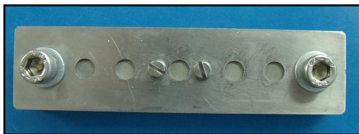
Figura 5. Matriz metálica utilizada para a confecção dos corpos-de-prova.
