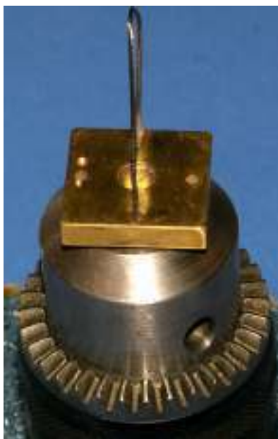
Figura 1 - Dispositivo para os testes de microtração.
