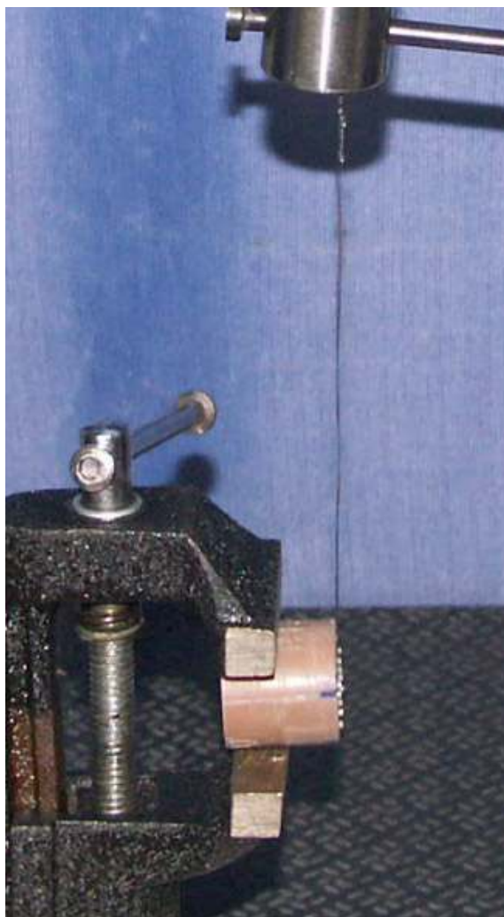
Figura 3 – Ensaio de microcisalhamento
