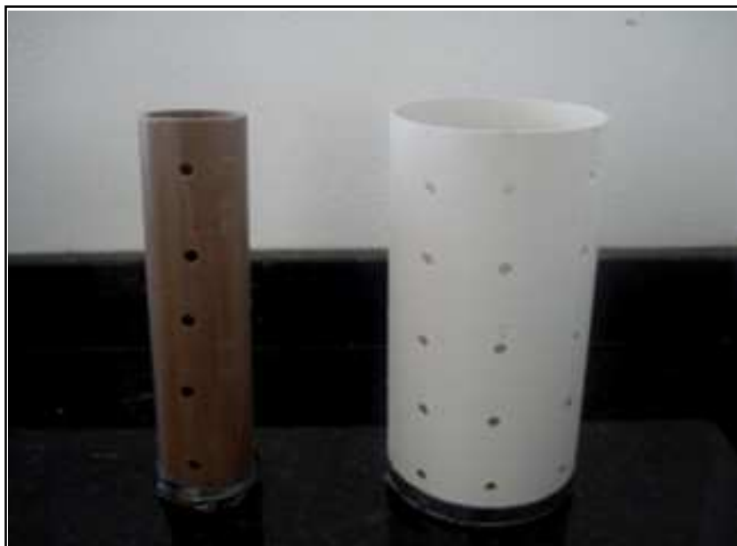
Figura 1.4 – Amostradores instalados nos tratamentos, confeccionados em tubos de PVC: 50 mm (menor) e 100 mm (maior). Embrapa Clima Temperado – Estação Experimental Cascata, Pelotas, RS, 2012.
