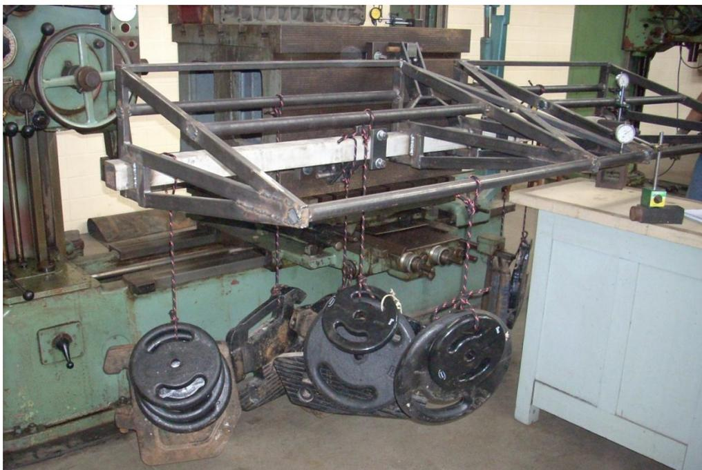
Figura 20 – Chassi com o máximo de carregamento vertical.
