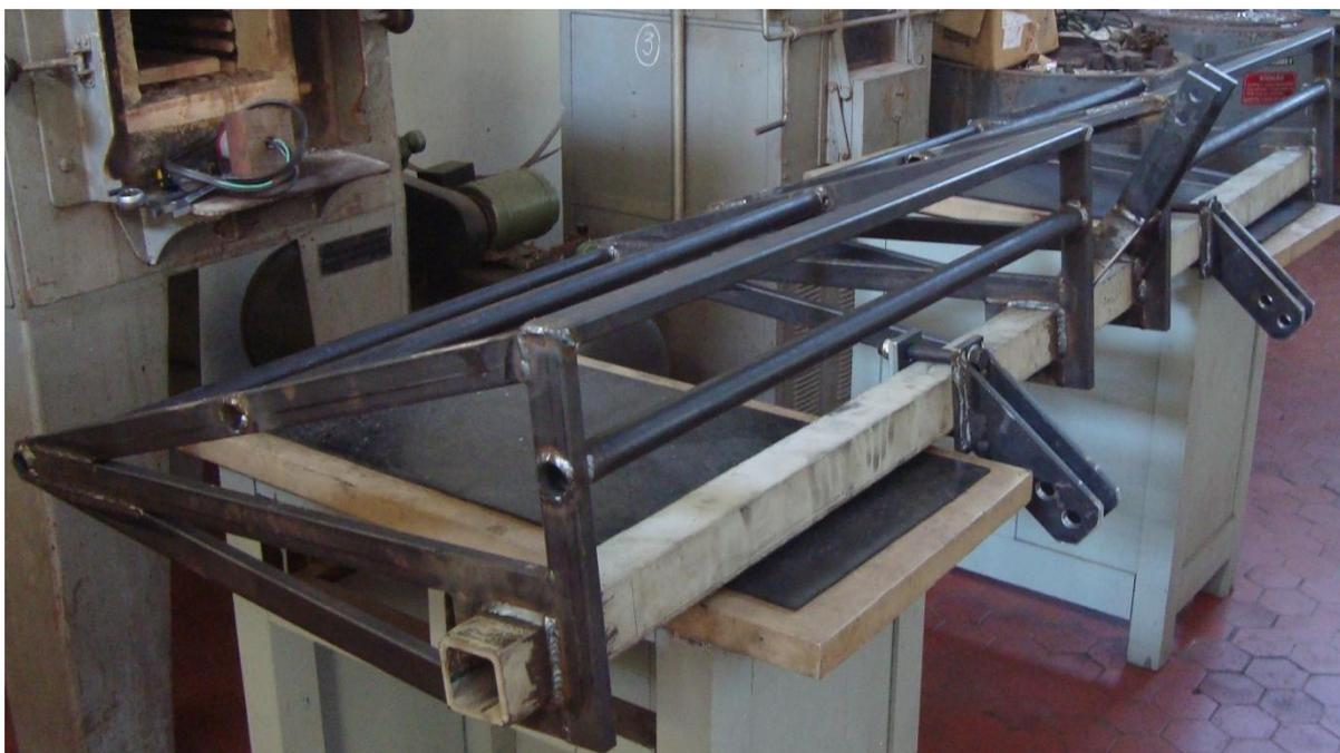
Figura 48 – Protótipo do chassi.
