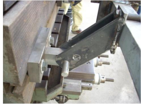
Figura 18 – Engate ao dispositivo de fixação
