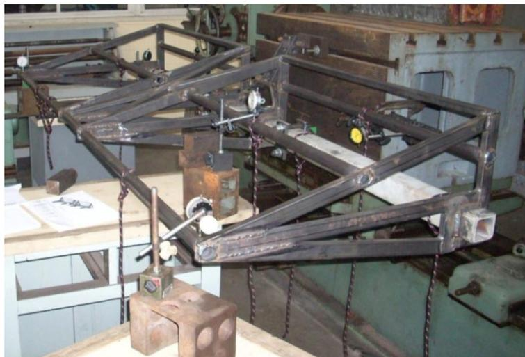
Figura 16 – Montagem do ensaio – posicionamento dos relógios no chassi e dos cabos para pendurar os pesos.
