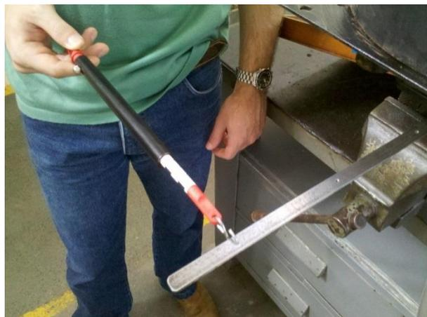
Figura 16 – Posicionamento para medição da força de acionamento.
