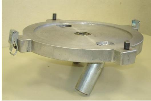
Figura 26- Vista lateral do corpo inferior com saída de sementes inclinada.
