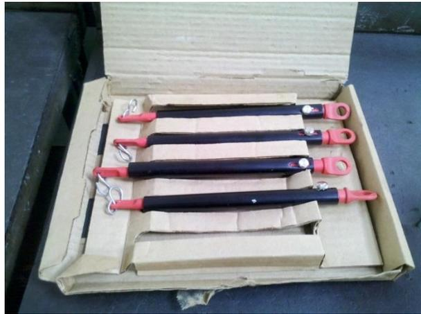
Figura 15 – Conjunto de dinamômetros.
