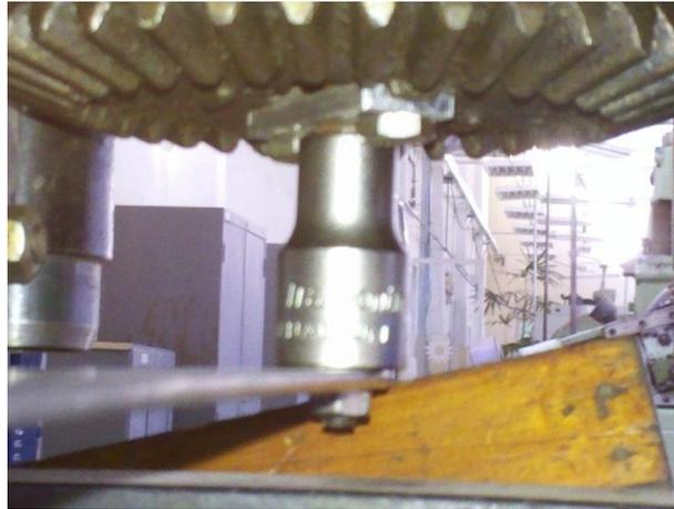
Figura 17 – Ponto de aplicação da força de acionamento.
