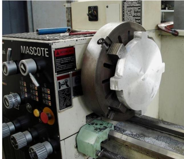
Figura 12 – Torno mecânico universal, IFSul – Mecânica.
