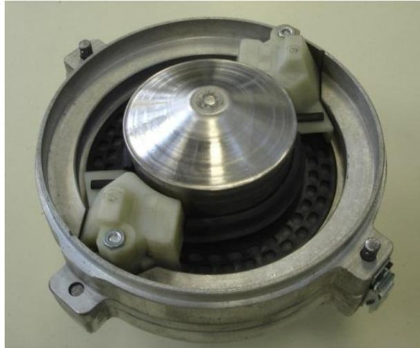
Figura 39 - Protótipo do dosador de sementes de disco horizontal com dupla saída.
