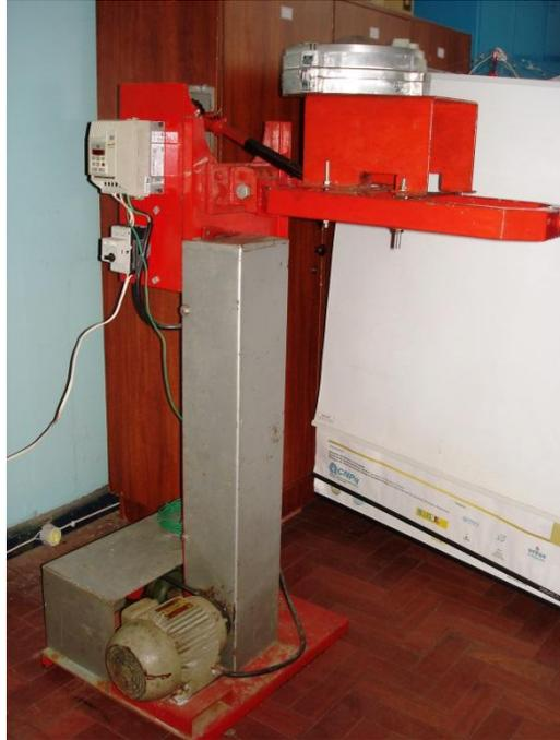
Figura 18 – Dosador de dupla saída montado na bancada de testes.
