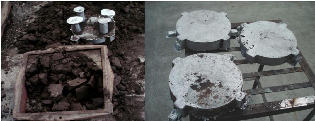
Figura 30 – Destorroamento manual.
