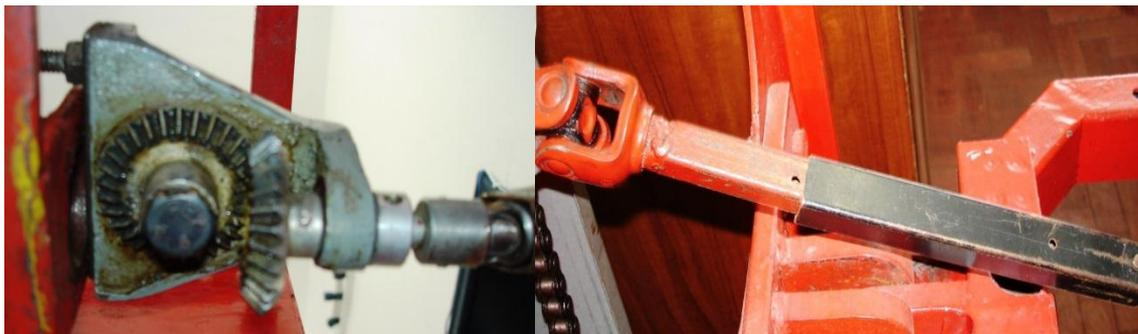
Figura 41 – Conjunto de engrenagens cônicas (esquerda) e eixo cardã (direita).
