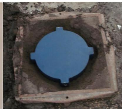
Figura 28 – Moldação manual em caixa de areia.
