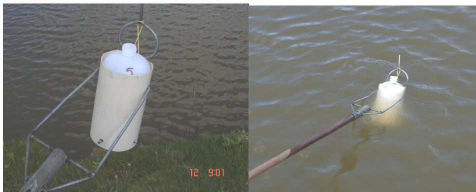
Figura 9 – Aparato desenvolvido para a coleta de amostra de água em açudes em que o frasco coletor fica encaixado em um cilindro oco de PVC preso a uma vara, Turuçu-RS.
