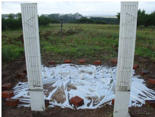
Figura 4 - Área e arranjo experimental utilizados para a determinação das curvas de calibração da sonda FDR em diferentes profundidades.
