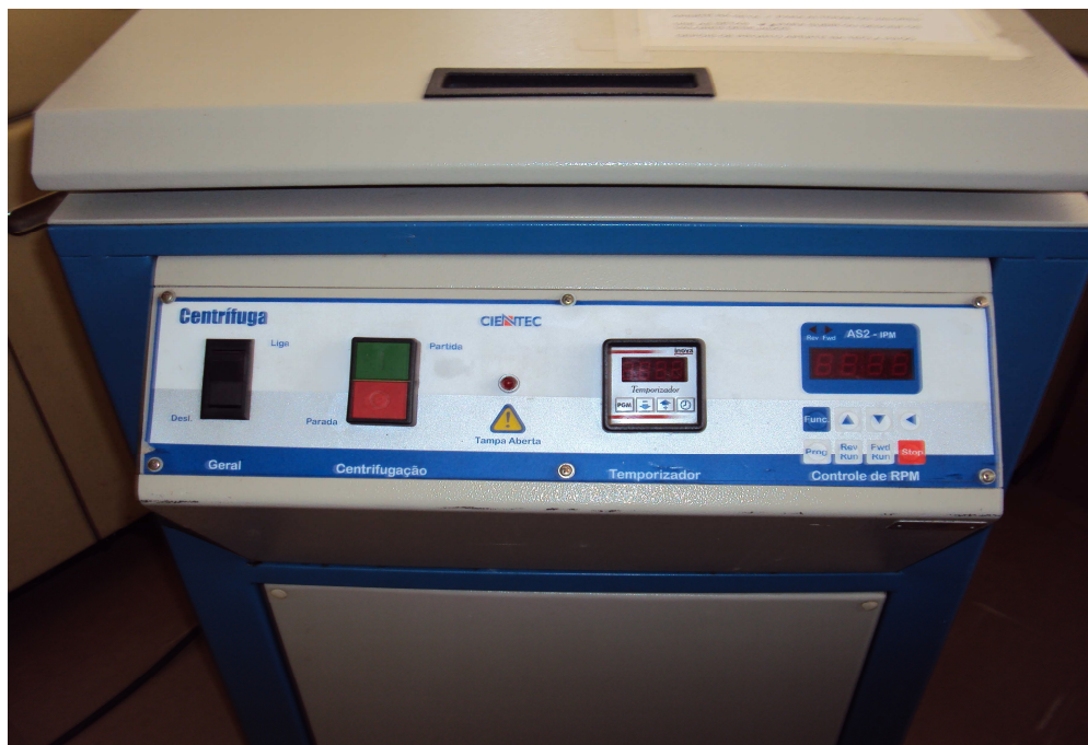
Figura 5: Painel de controle da centrífuga.
