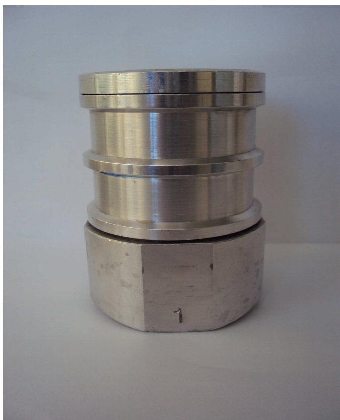
Figura 3: Cilindro utilizado para a centrifugação das amostras.
