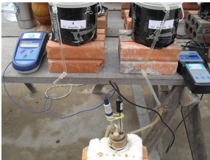
Figura 5- Eletrodos específicos, combinados, ligados a um potenciômetro e previamente instalados em uma “célula eletrométrica”.
