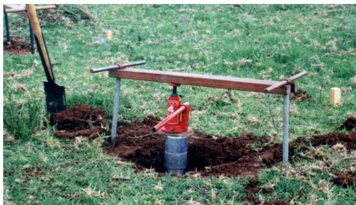
**FIGURA 10:** Sistema hidráulico de coleta de amostras indeformadas de solo
