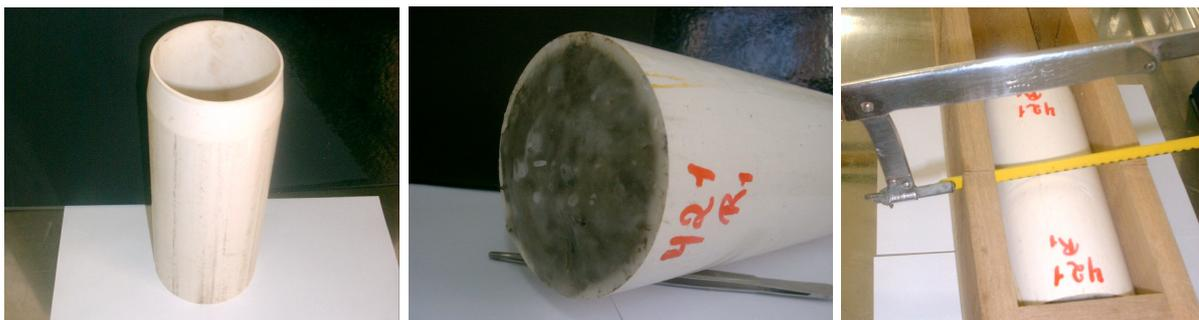
Figura 7 – Preparo de amostras: a) cilindro usado na coleta; b) vista do topo da amostra preenchido com parafina; e c) serra e moldura de madeira, utilizadas para seccionar a amostra.
