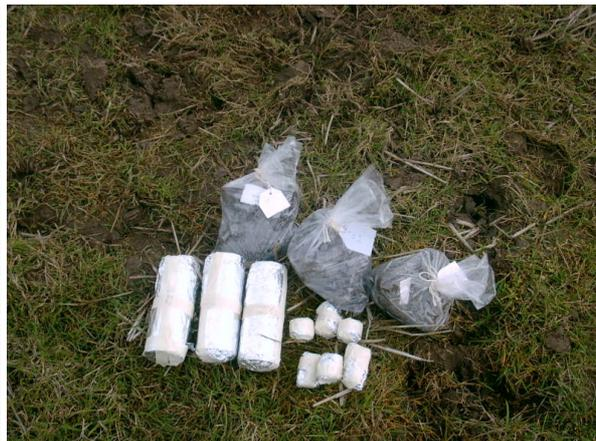
Figura 6 – (a) Método do Macaco Hidráulico utilizado na coleta de amostras com estrutura preservada e (b) procedimento de embalagem para o transporte.
