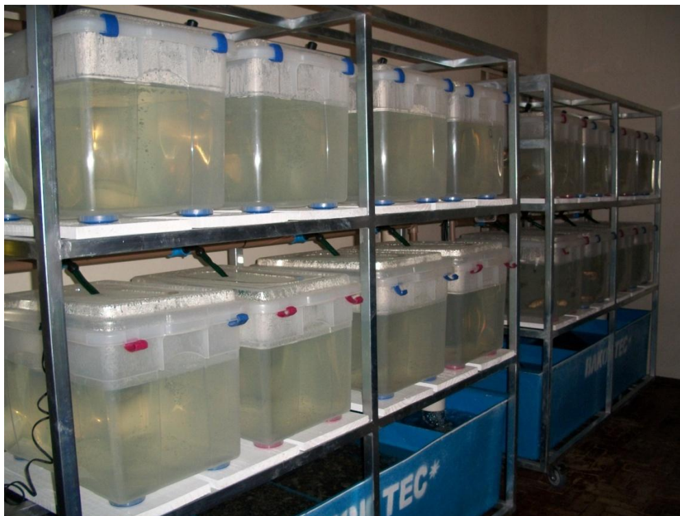
Figura 1 – Sistema de recirculação de água do Laboratório de Engenharia Genética Animal da Universidade Federal de Pelotas.
