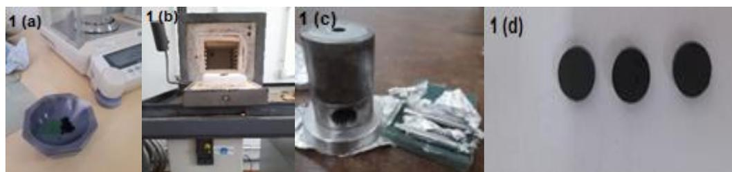
Figura 1: (a) Balança de precisão e Almofariz de ágata. (b) Forno industrial. (c) Pastilhador. (d) Amostras
