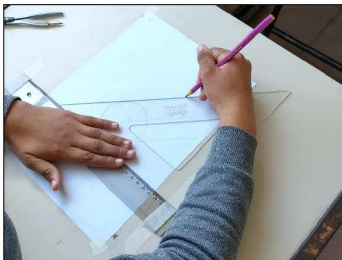
Figura 131 – *Régua fixa, esquadro e compasso* (Régua de 30 cm. fixada em carteira escolar com fita crepe, esquadro de 45 graus e compasso).
