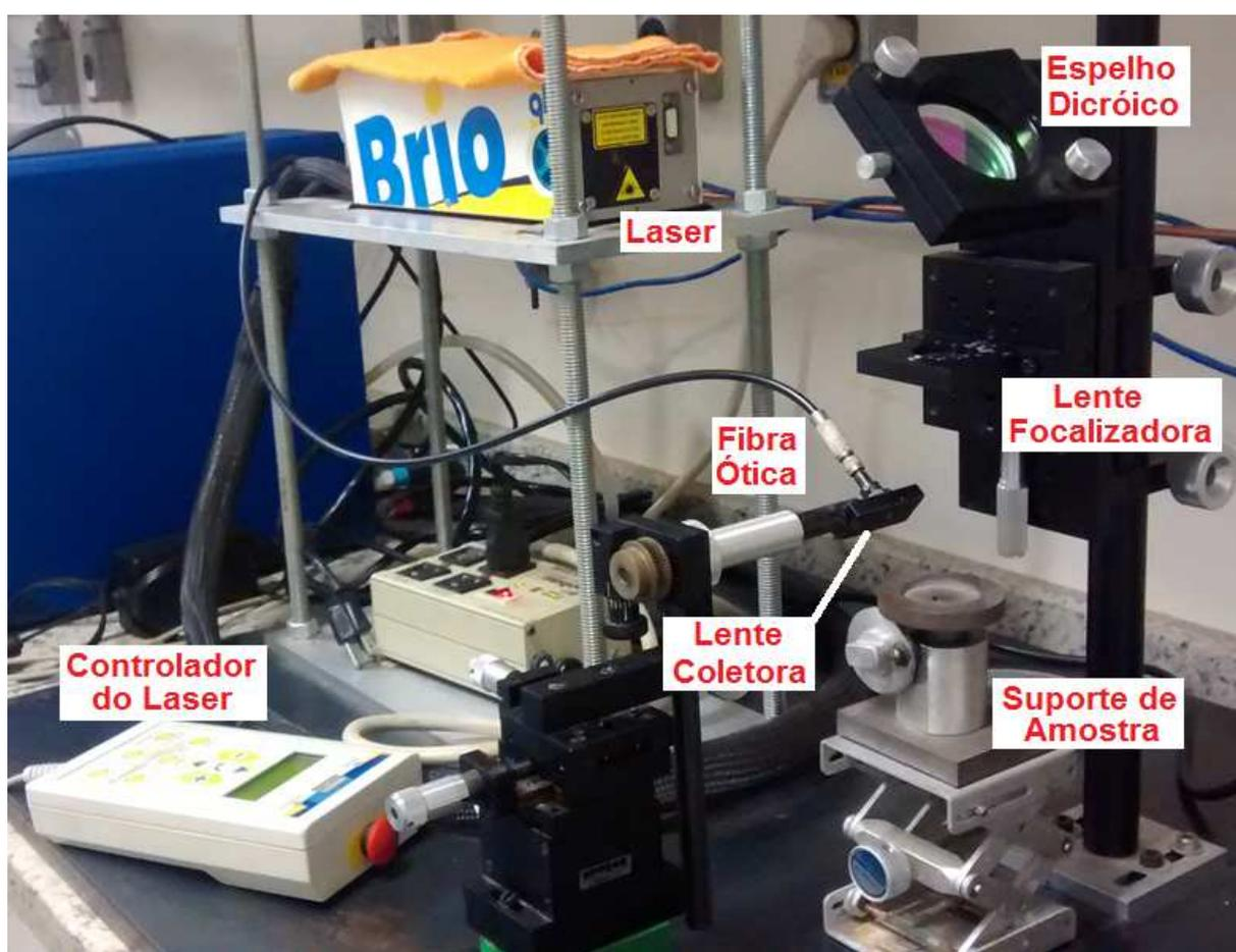
Figura 33 – Fotografia do equipamento LIBS utilizado.
