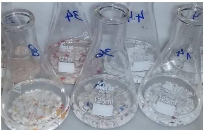
Figura 31 – Fragmentos cerâmicos imersos em uma solução de  $\text{CH}_3\text{COOH}$  para posterior avaliação da concentração lixiviada de Cd, Cr e Pb.
