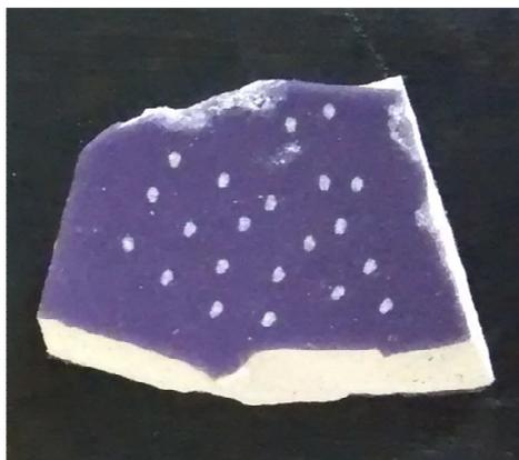
Figura 36 – Crateras formadas na superfície de uma amostra cerâmica após análises por LIBS.
