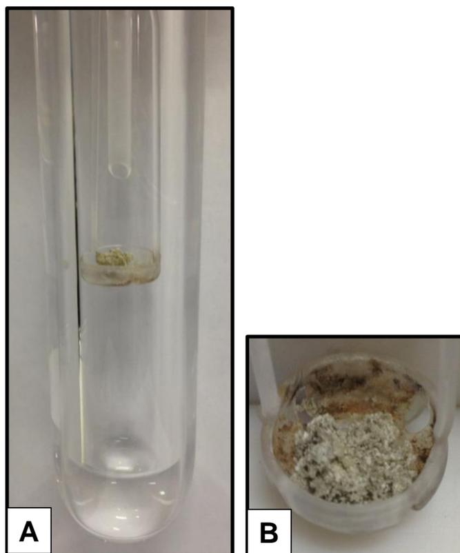
**Figura 19.** Aspecto da solução (A), e do resíduo no suporte (B) considerando o preparo de 100 mg de  $\text{CaCO}_3$  + 300 mg de amido após a decomposição por MIC.
