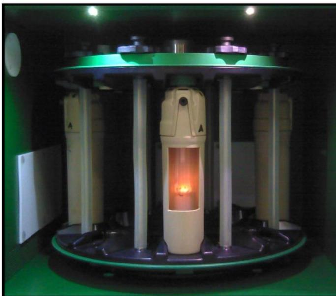
**Figura 8.** Visualização da combustão de 100 mg de CaCO<sub>3</sub> com 300 mg de amido.
