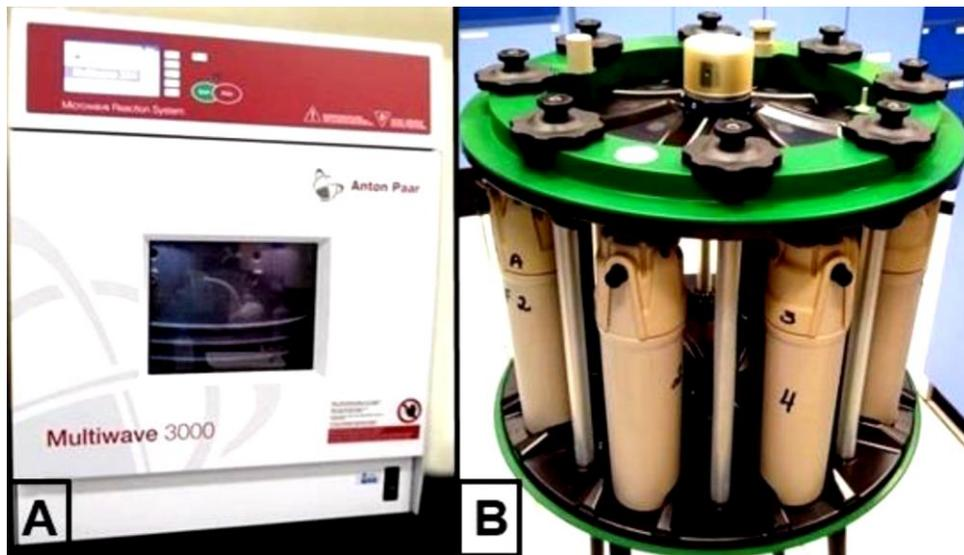
**Figura 3.** Equipamento utilizado para o preparo de amostras: A) Forno de micro-ondas Multiwave 3000<sup>®</sup> e B) rotor equipado com oito frascos (Adaptada de PEREIRA, 2014).
