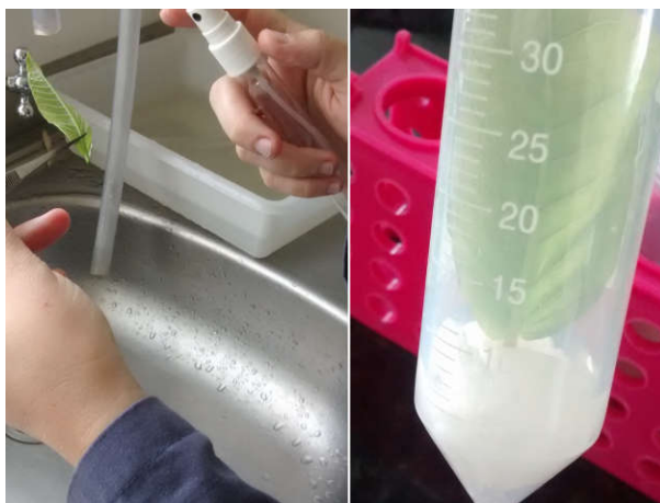
Figura 4: Processo de recobrimento de folhas de goiabeira cv. Paluma com filme de quitosana e acondicionamento em tubo Falcon para verificação da toxicidade
