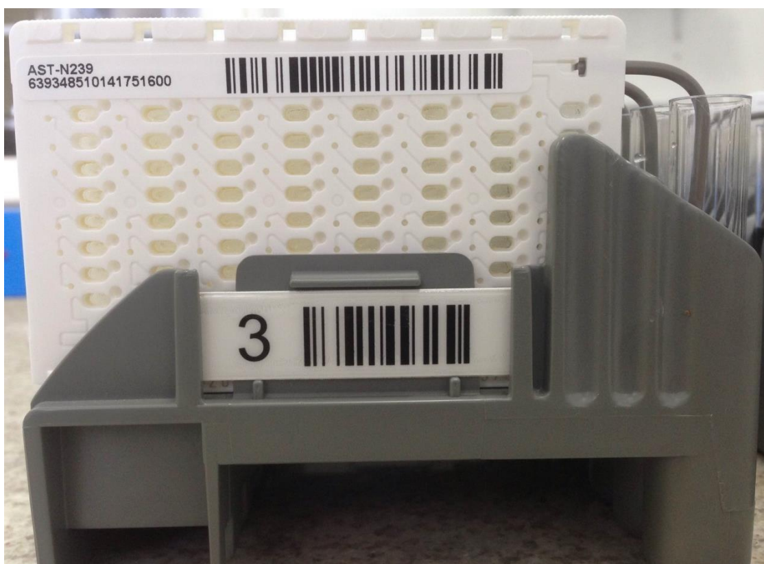
Figura 4: Cartão para antibiograma específico para bactérias Gram Negativas (GN) fermentadoras ou não fermentadoras utilizado no VITEK 2.
