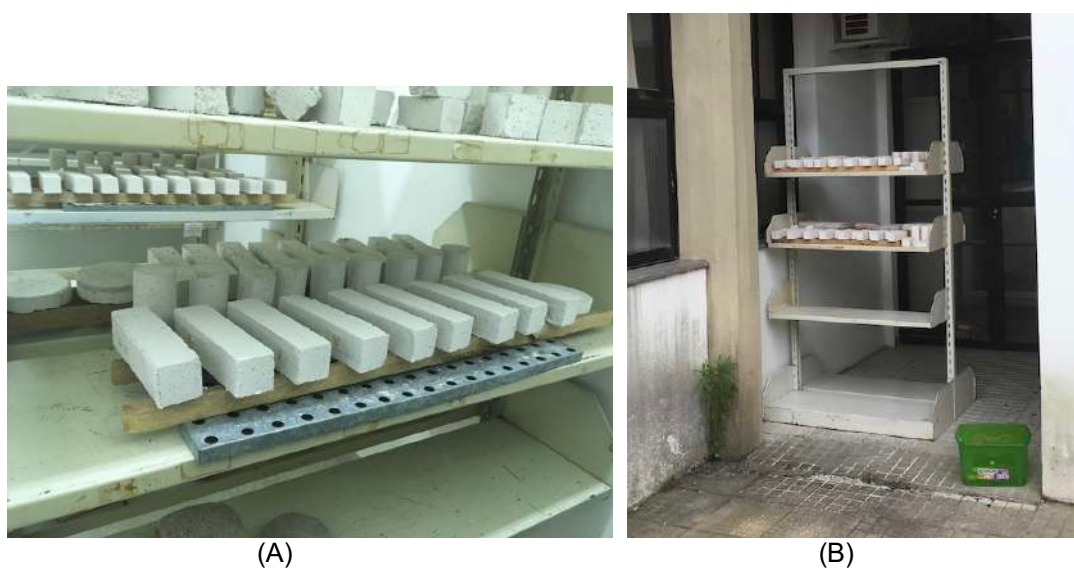
Figura 31- Processo de cura dos corpos de prova. (A) ambiente interno no laboratório, (B) ambiente externo ao laboratório.
