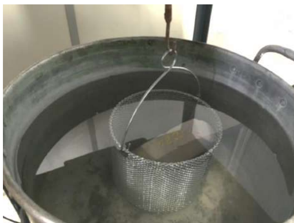
Figura 37- Pesagem hidrostática dos corpos de prova após o processo de imersão total e fervura.
