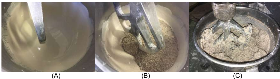
Figura 27- Processo de mistura e homogeneização das matérias-primas utilizadas nas formulações das novas argamassas.
