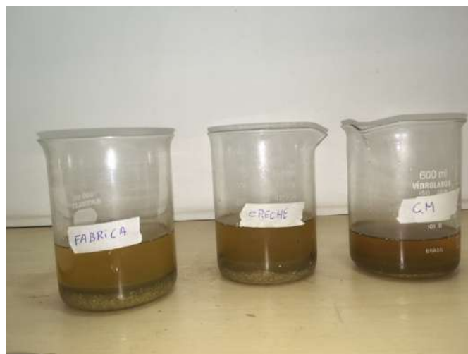
Figura 8- Dissolução ácida das amostras coletadas.
