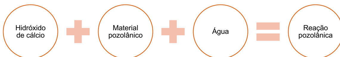
Figura 3- Esquema de reação pozolânica.
