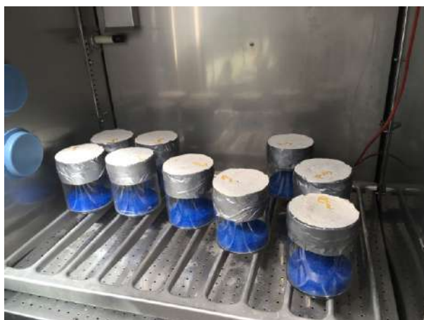
Figura 40- Ensaio de permeabilidade ao vapor. Corpos de prova no interior da câmara de climatização.
