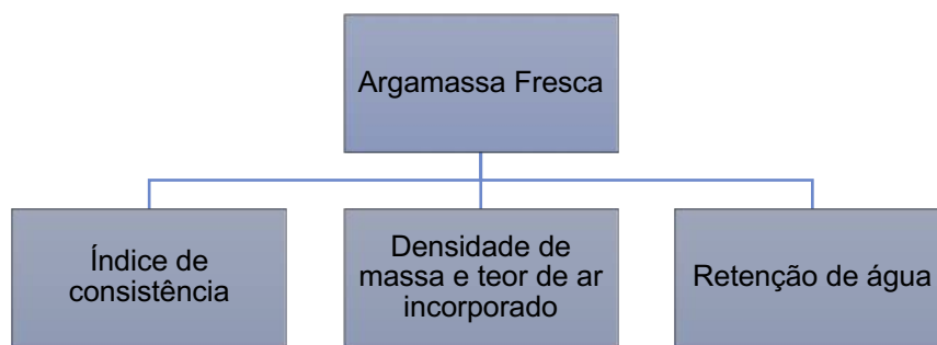
Figura 32- Organograma dos ensaios realizados nas argamassas no estado fresco.
