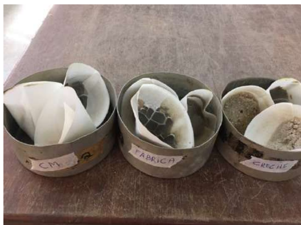
Figura 10- Resíduo insolúvel das argamassas.
