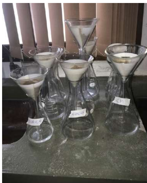
Figura 9- Filtragem do resíduo através de lavagem.
