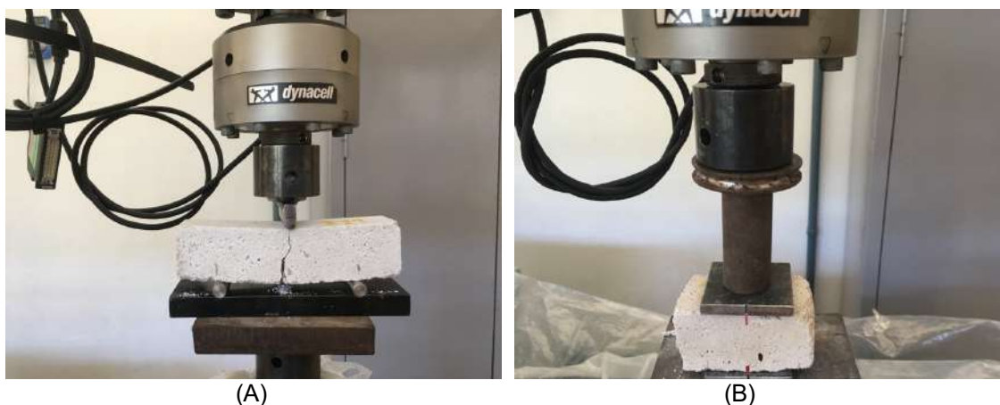
Figura 34- Ensaio de resistência mecânica. (A) Tração na flexão, (B) Compressão.
