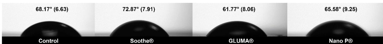
Figura 3. Diferenças no ângulo de contato com a água para os diferentes grupos de dessensibilizantes.
