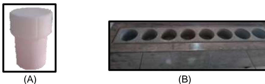
Figura 5 – Frasco de PTFE fechado (A) e bloco digestor (B).
