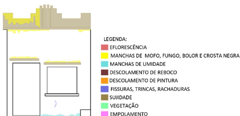
Figura 04 – Mapa de danos, edificação nº4256
