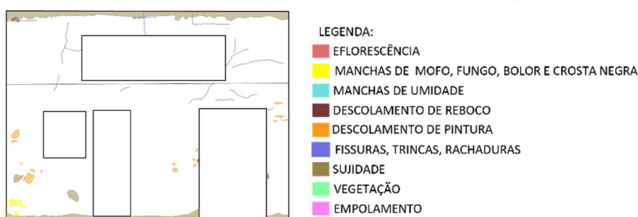
Figura 02 – Mapa de danos, edificação nº08.
