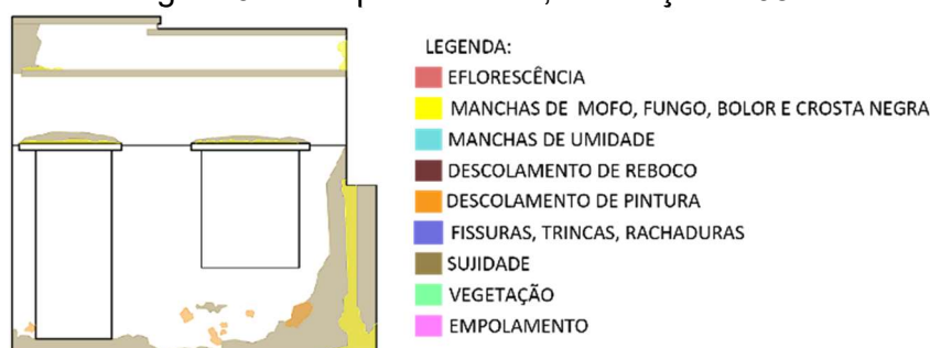
Figura 03 – Mapa de danos, edificação nº4323
