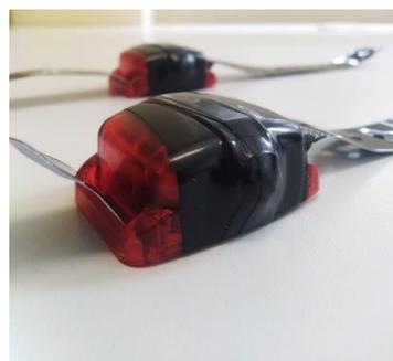
**Figura 6** - Acelerômetros com fita isolante para evitar a umidade interna no dispositivo
