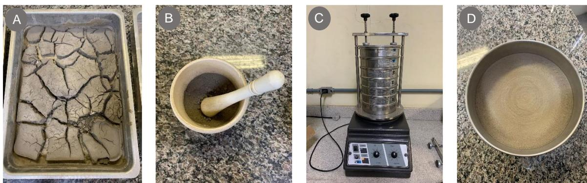
Figura 15 – Análise granulométrica etapas método de peneiramento: (A) secagem sedimento coletado; (B) destorroamento sedimento; (C) processo de peneiramento em rotap; (D) sedimento retido na peneira de fundo.
