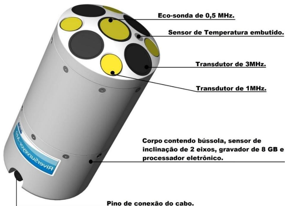
Figura 6 – Componentes do ADCP M9 da Sontek.
