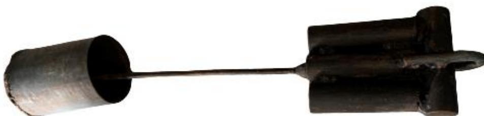
Figura 14 – Amostrador de sedimento de fundo do tipo Rock-Island.
