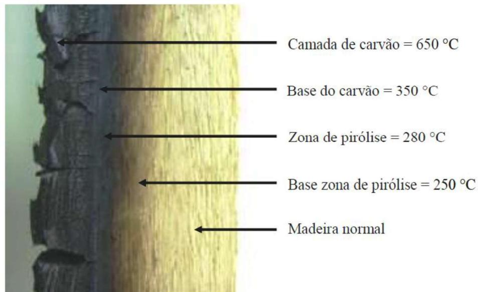
Figura 02: Camadas de madeira alterada por energia térmica
