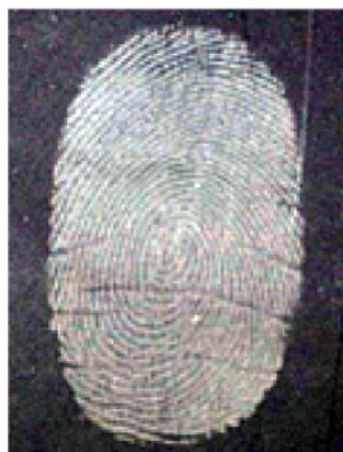
Figura 5 – Impressão digital latente revelada utilizando sílica modificada com 50:1 (m/m) SiO 2 /4-4-(clorometil)feniltriclorossilano.
