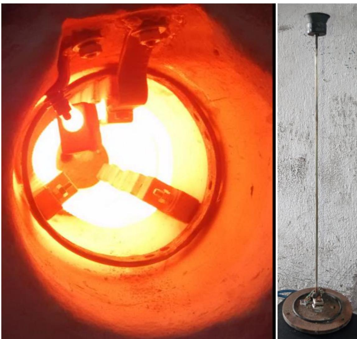
Figura 37 – Forno tubular com a resistência de 5kW em funcionamento na esquerda e a balança de precisão e o cadinho das amostras na direita.
