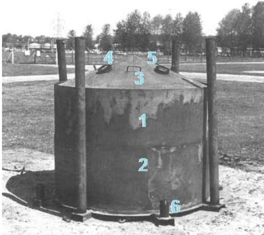
Figura 9 – Forno de metal portátil.
