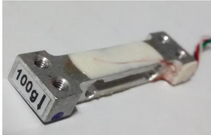
Figura 24 – Célula de carga de 100g.
