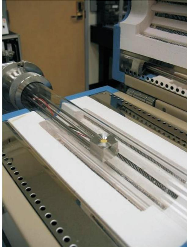
Figura 17 – Bancada experimental, com o sensor e o forno tubular.
