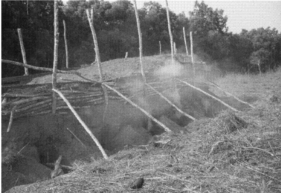
Figura 3 – Forno tipo monte horizontal.
