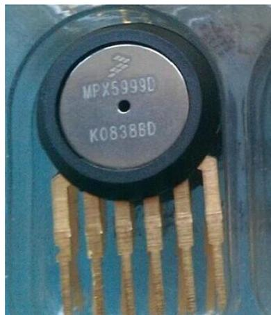
Figura 27 – Sensor de pressão MPX5999D.
