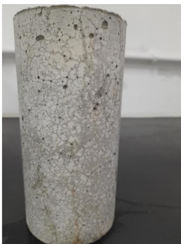
Figura 20 – Fotografia de um concreto apresentando fissuras superficiais após 15 ciclos.
