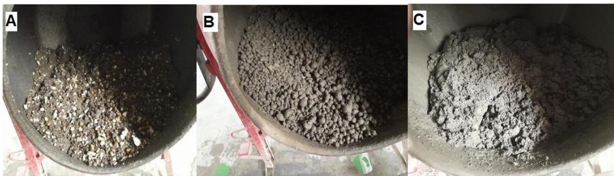
Figura 12 – (A) mistura água, areia e RPUF; (B) após adição de cimento; (C) adição de restante da água e aditivo superplastificante.
