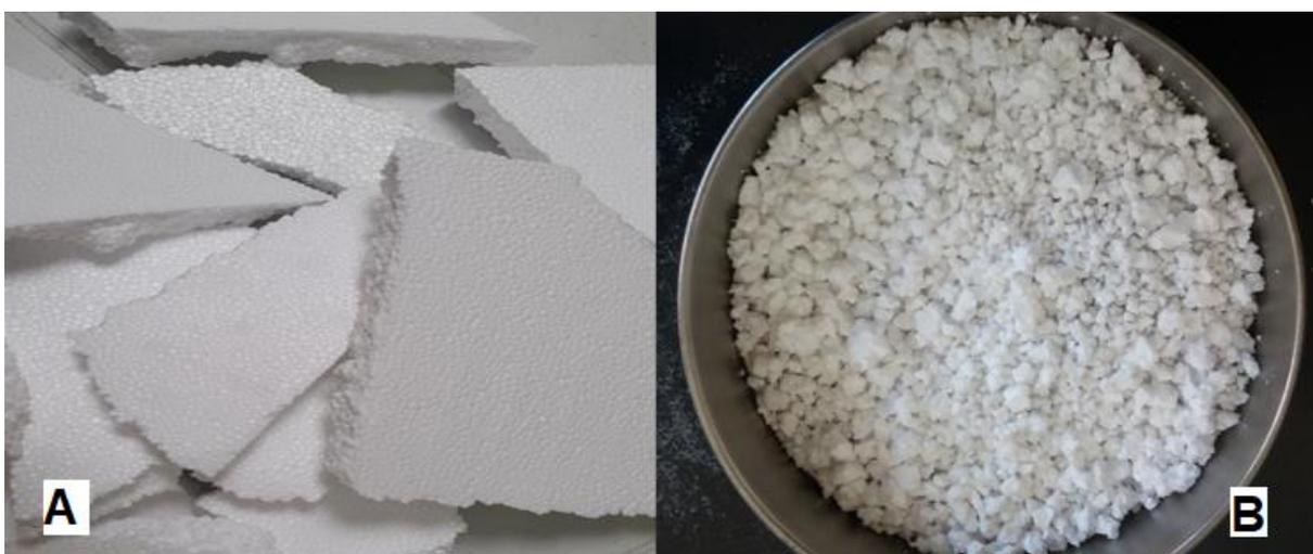
Figura 5 - Resíduos de EPS *in natura* (A) e após o processo de moagem (B).
