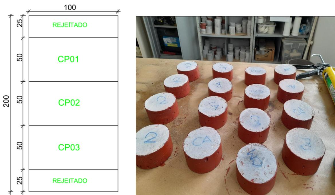
Figura 16 - Preparação das amostras para o ensaio.
