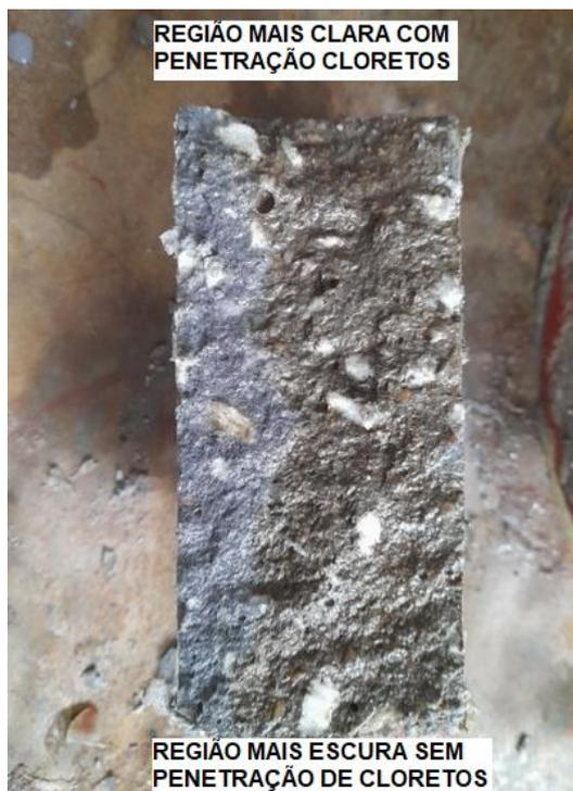
Figura 18 - Corpo de prova mostra a região onde ocorreu a penetração de cloretos.
