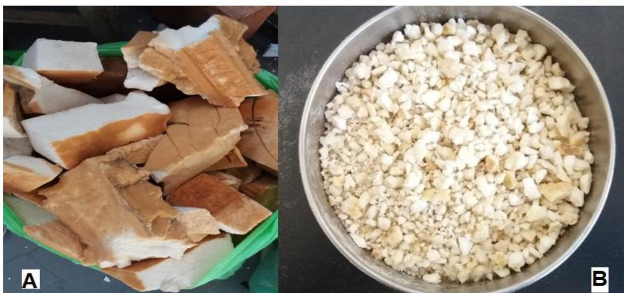
Figura 4 - Resíduos de RPUF *in natura* (A) e após o processo de moagem (B).
