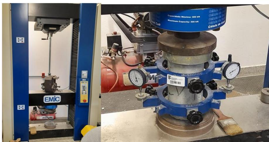
Figura 13 - Prensa Emic e o corpo de prova com as bases independentes e os relógios comparadores instalados, pronto para o ensaio.
