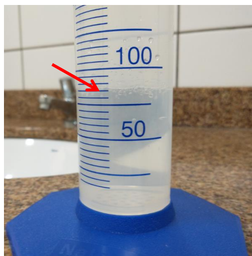
Figura 10: Medição do vazamento de água do mictório durante 60 minutos. Fonte: Autor.
