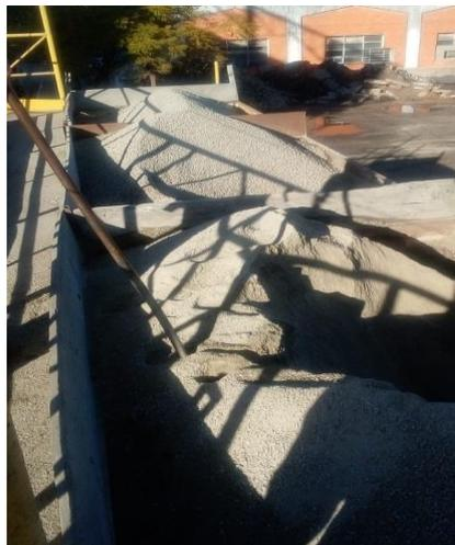
Figura 17 - Agregados dispostos nos silos dosadores
