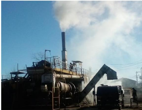
Figura 23 - Usina de asfalto em produção
