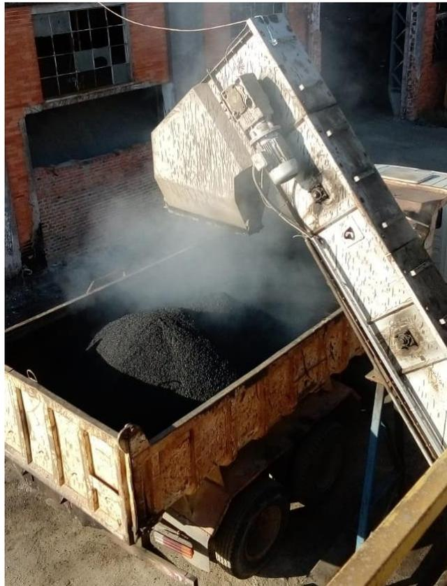
Figura 25 - Coifa da usina descarregando o asfalto no caminhão
