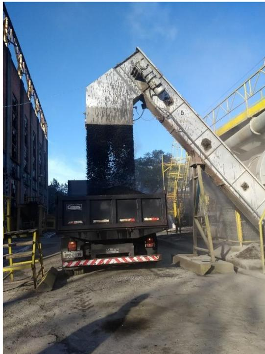
Figura 9 - Carregamento dos caminhões com a mistura asfáltica pronta
