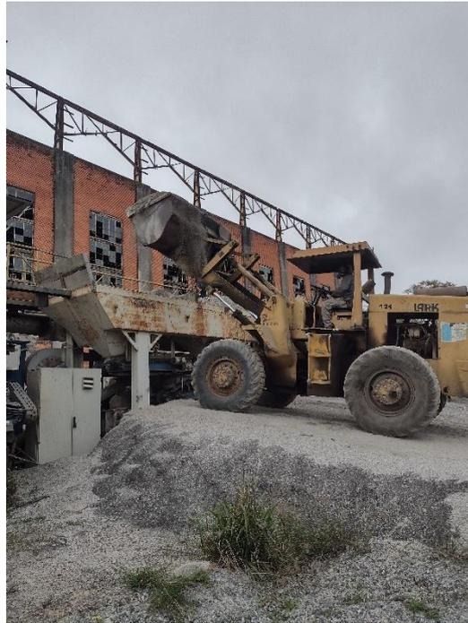
Figura 19 - Pá carregadora abastecendo os silos dosadores com agregados
